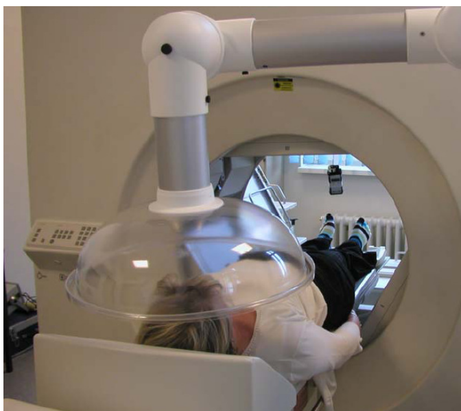
Abb. 2.2-1: Beispiel für die Anwendung einer Absaugglocke [PET 06] (typische Saugleistung 300 m 3 /h während und nach Ventilation über Patientenkopf positioniert)
